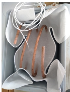
Рис. 3 – Внешний вид источника естественного холода с теплообменником и температурным датчиком (до заморозки воды)
