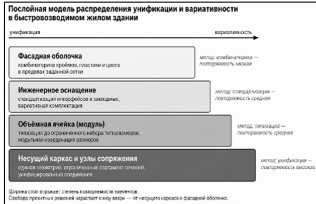
Рисунок 3 — Послойная модель распределения унификации и вариативности в быстровозводимом жилом здании
